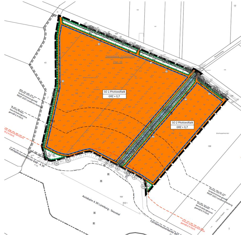
Gemäß EEG ist ein Korridor zwischen 40 m und 500 m möglich. Bis zum Wirtschaftsweg besteht eine Tiefe von bis zu 380 m. Insgesamt steht eine Fläche von ca. 12 ha zur Verfügung und ist über entsprechende Verträge mit den Eigentümern für 20 + 5 + 5 Jahre gesichert.
